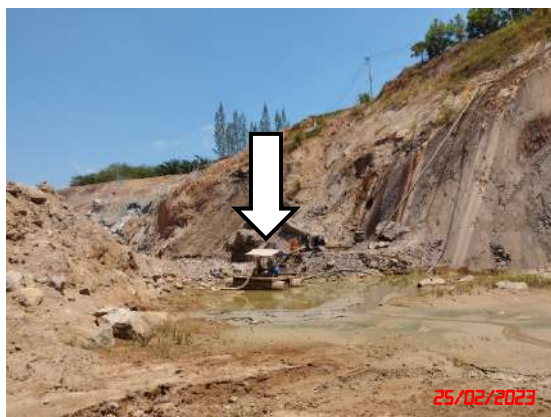
รูปที่ 27 บ่อรับน้ำ (Sump)
